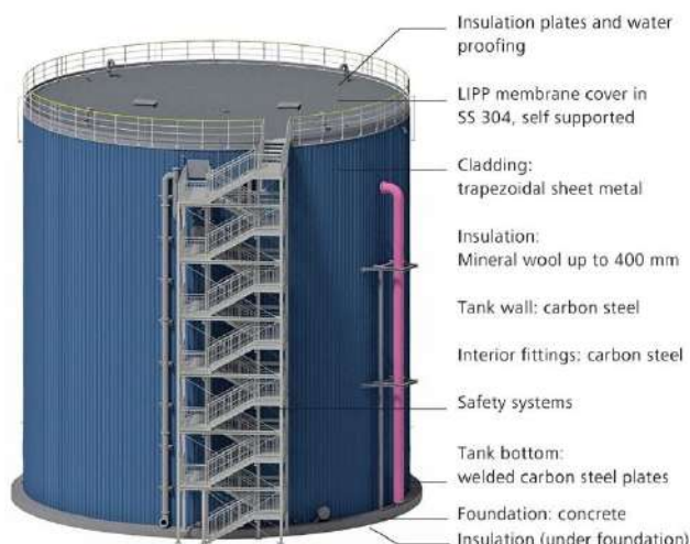
Figura 25. Stocarea energiei termice în rezervoare (sursă)
